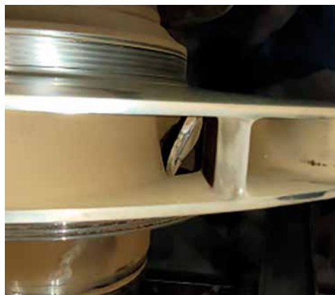
Рисунок 5.71. Посторонний предмет в рабочем колесе ЦБК
