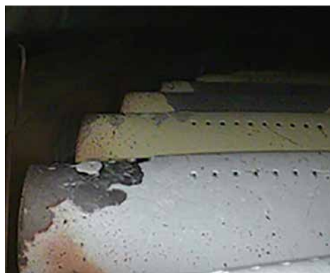
Рисунок 5.28. Износ термобарьерного покрытия рабочей лопатки 1-й ступени ТВД (наработка 10 000 часов)
