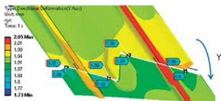
Рисунок 6.26. Натяг на стыке бандажных полок
