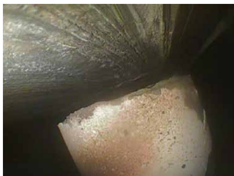
Рисунок 5.29. Износ реборды рабочей лопатки 1-й ступени и обоймы уплотнения
