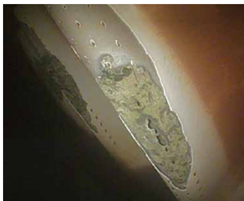
Рисунок 5.27. Износ входных рабочих лопаток 1-й ступени ТВД (наработка 44 000 часов)
