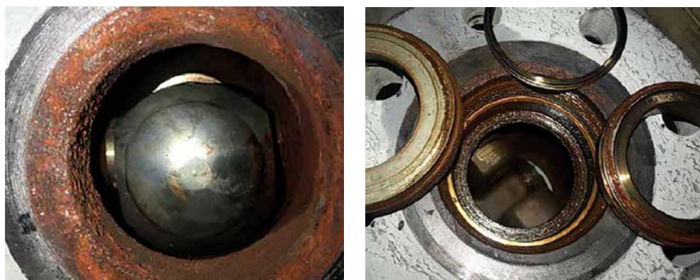
Рисунок 5.53. Отложения на элементах продувочного клапана
