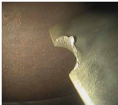
Рисунок 5.49. Повреждение рабочей лопатки ОК
