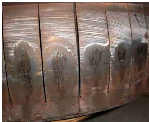
Рисунок 5.22. Разрушение ободочного лепесткового уплотнения жаровой трубы (наработка 24 000 часов)
