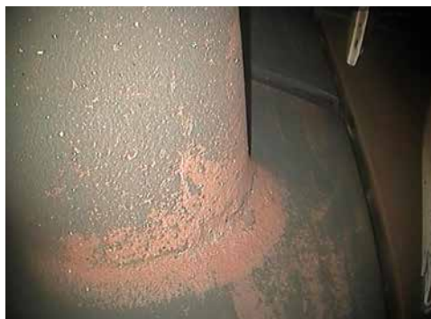
Рисунок 5.26. Эрозионный износ входной кромки соплового аппарата 2-й ступени ТВД (наработка 16 107 часов)
