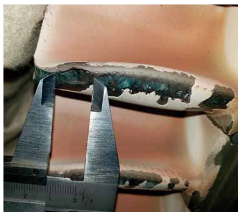
Рисунок 5.31. Повреждение входной кромки рабочей лопатки первой ступени ТВД (наработка 4032 часа)
