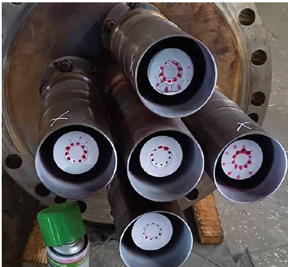
Рисунок 5.10. Бескартриджные крышки (наработка 16 900 часов, дефектные форсунки помечены «X»)
