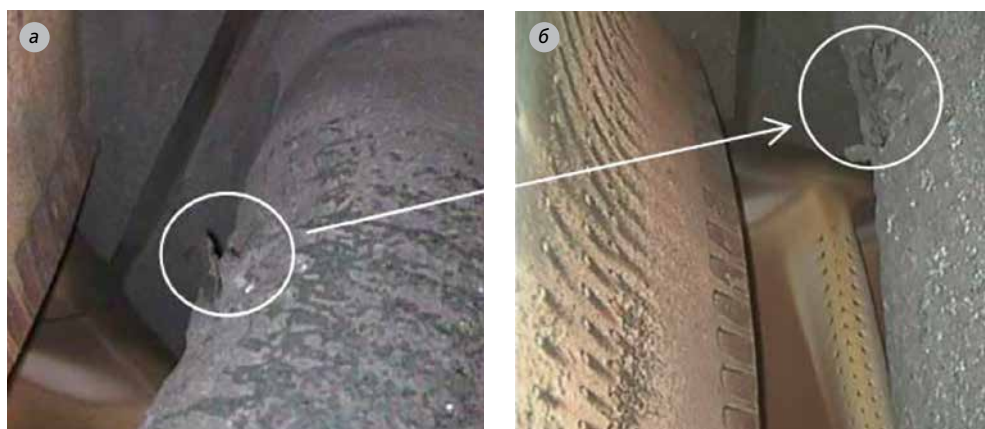
Рисунок 5.24. Динамика прогара сопловой лопатки 1-й ступени ТВД: а) октябрь 2015 г.; б) февраль 2016 г.
