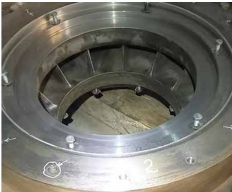
Рисунок 5.69. Места обрыва крепежа диффузора 2-й ступени
