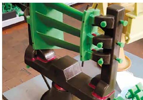
Рисунок 6.21. Блок восковой модели сопловой лопатки ТНД и литниковой системы
