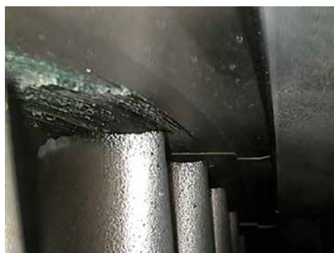
Рисунок 5.29. Износ реборды рабочей лопатки 1-й ступени и обоймы уплотнения
