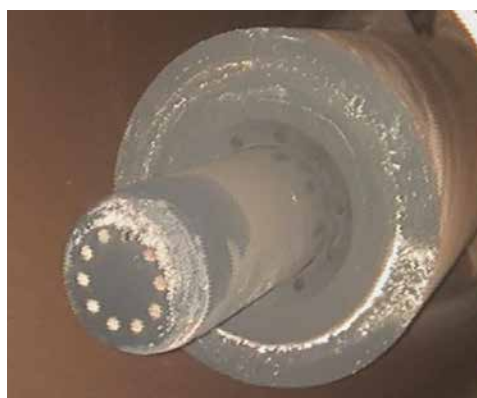
Рисунок 5.4. Обломленный картридж форсунки (ТО-24000)
