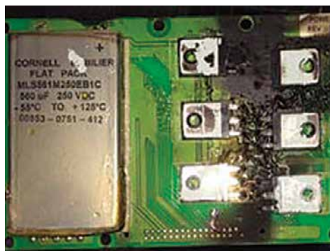
Рисунок 5.52. Выгорание на плате блока управления
