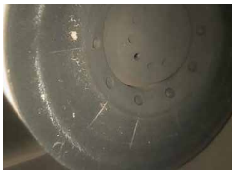
Рисунок 5.8. Бороскопический осмотр (наработка 16 000 часов)
