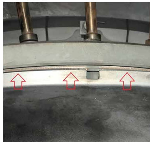
Рисунок 5.36. Смещение наружного переходного патрубка вниз из пазов соплового аппарата первой ступени ТНД (наработка 23 437 часов)
