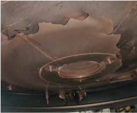
Рисунок 5.40. Разрушение крышки теплового экрана, вид сверху (наработка 45 079 часов)
