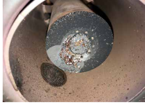
Рисунок 5.5. Загрязнение форсунки картриджного типа (наработка форсунок 8863 часа)
