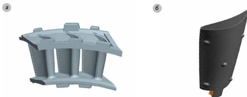
Рисунок 6.35. Сопловая лопатка 2-й ступени ТВД: а) общий вид лопаток с охлаждающими каналами; б) дефлектор внутри лопатки
