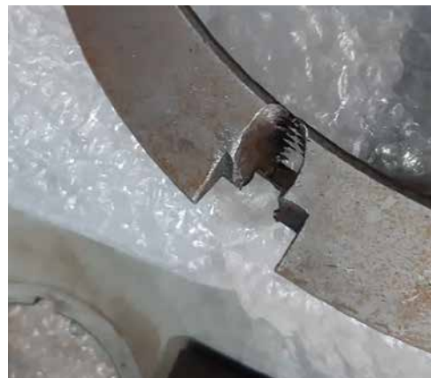
Рисунок 5.70. Гайка крепления рабочего колеса и разрез для ее удаления
