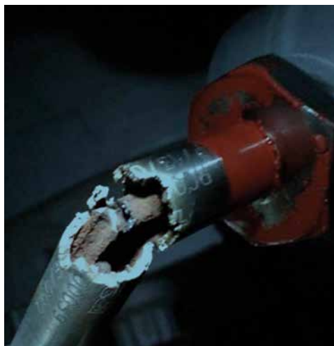
Рисунок 5.15. Пример разрушения воспламенителя в районе клеммной коробки и у зажимной гайки
