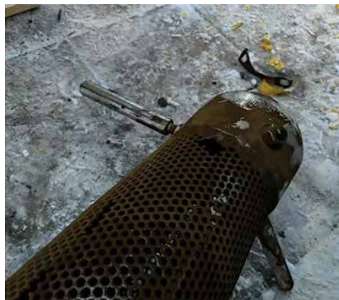
Рисунок 5.72. Поврежденный конусный фильтр
