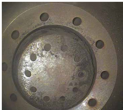
Рисунок 5.3. Неравномерные зазоры в наконечнике с картриджем пассивной продувки (наработка 3847 часов)
