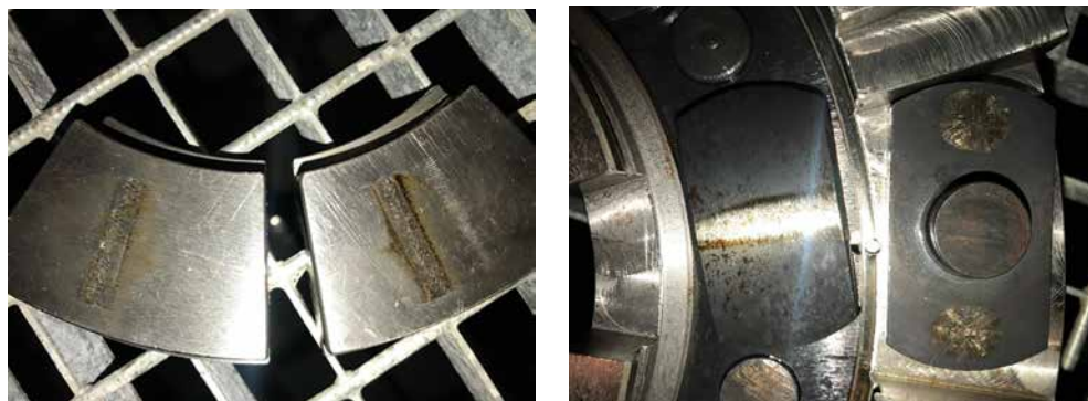
Рисунок 5.64. Износ элементов упорного подшипника
