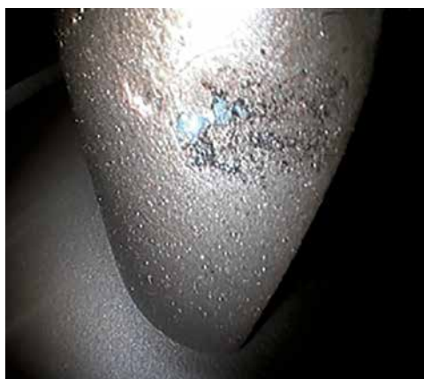
Рисунок 5.33. Повреждение рабочей лопатки второй ступени ТВД (наработка 4032 часа)
