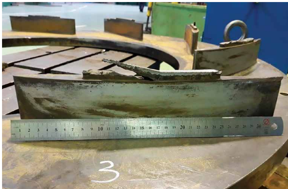
Рисунок 5.67. Трещина на лопатке диффузора 2-й ступени
