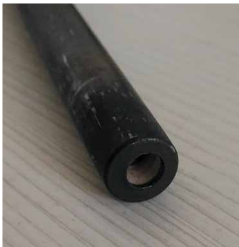
Рисунок 5.16. Наконечник воспламенителя без центрального электрода
