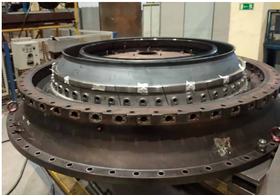
Рисунок 6.28. Контрольная сборка локализованного модуля ТНД
