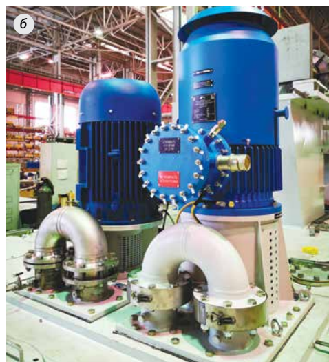
Рисунок 6.47. Аварийный и вспомогательный маслонасосы: а) иностранного производства; б) отечественного производства
