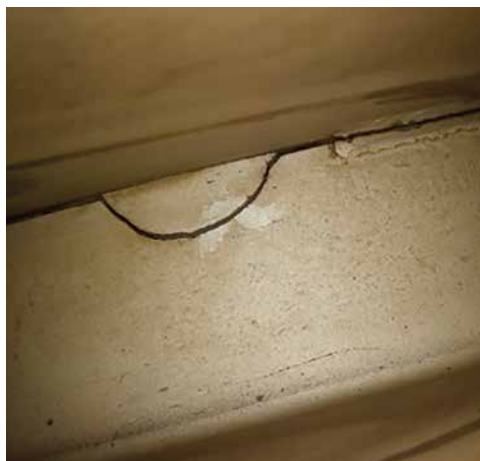
Рисунок 5.66. Трещина на лопатке диффузора 1-й ступени
