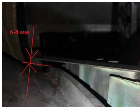
Рисунок 5.37. Велчина деформации наружного переходного патрубка по плоскостям (наработка 23 437 часов)
