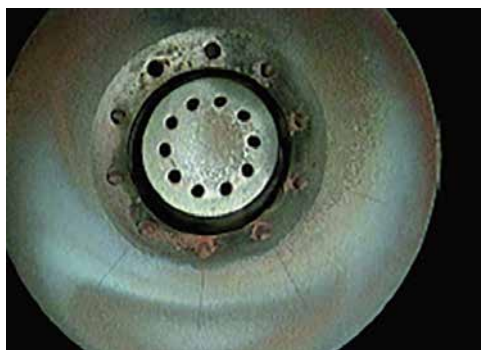
Рисунок 5.7. Бороскопический осмотр (наработка 14 620 часов)
