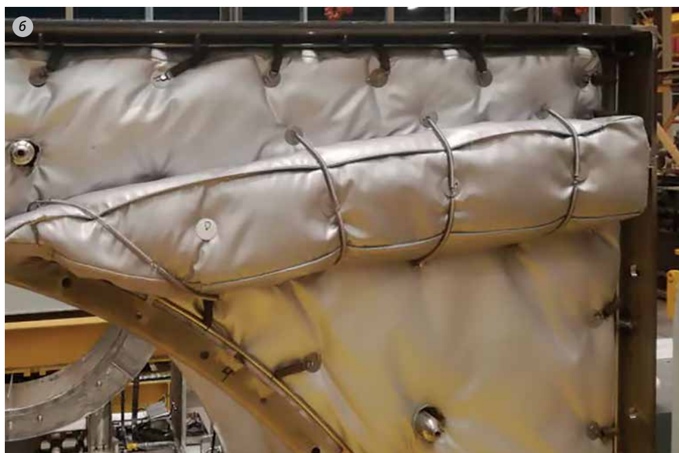
Рисунок 5.47. Места установки дополнительной изоляции выхлопного патрубка: а) места установки дополнительной изоляции выхлопного патрубка; б) дополнительная изоляция выхлопного патрубка
