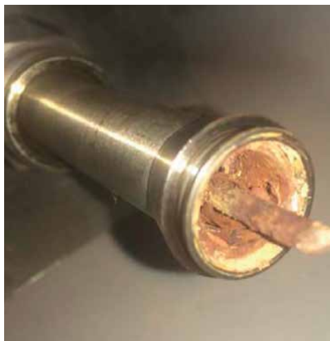
Рисунок 5.15. Пример разрушения воспламенителя в районе клеммной коробки и у зажимной гайки
