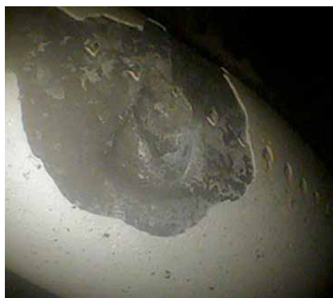
Рисунок 5.32. Повреждение термозащитного покрытия рабочей лопатки первой ступени ТВД (наработка 20 216 часов)
