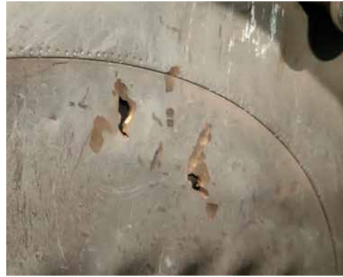
Рисунок 5.41. Пробоины в верхней части переднего эллиптического экрана
