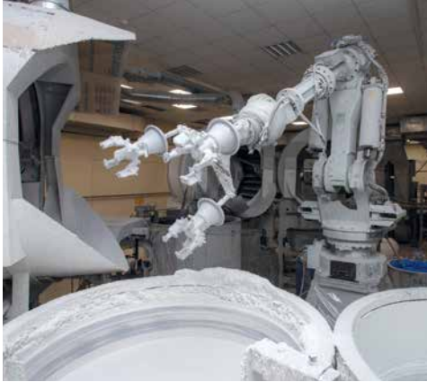
Рисунок 6.22. Робот-манипулятор и ванны с суспензией и обсыпкой
