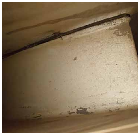
Рисунок 5.66. Трещина на лопатке диффузора 1-й ступени
