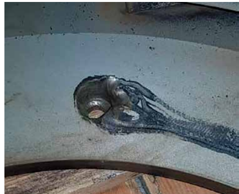
Рисунок 5.69. Места обрыва крепежа диффузора 2-й ступени
