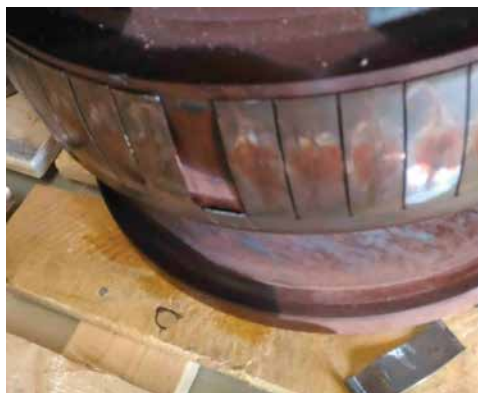
Рисунок 5.22. Разрушение ободочного лепесткового уплотнения жаровой трубы (наработка 24 000 часов)
