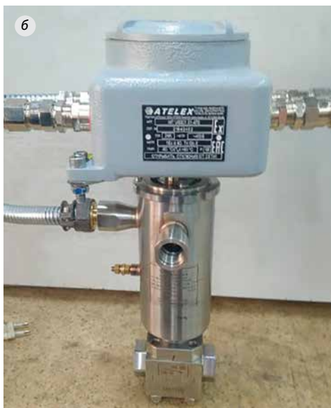
Рисунок 6.50. Клапан сбросной высокотемпературный: а) иностранного производства; б) отечественного производства
