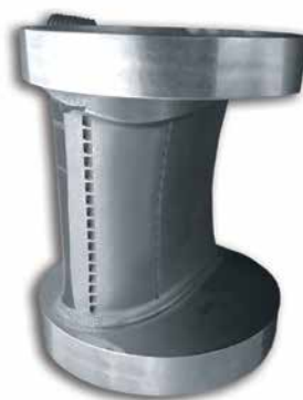
Рисунок 6.40. Демонстраторы: а) направляющая лопатка ТВД; б) часть пера рабочей лопатки ТВД 1-й ступени
