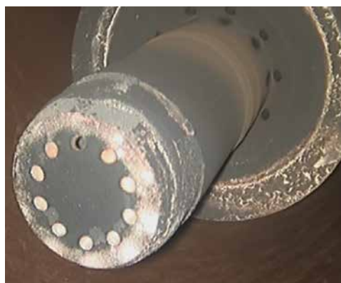
Рисунок 5.4. Обломленный картридж форсунки (ТО-24000)
