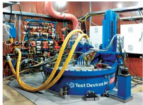
Рисунок 6.14. Стенд для проведения автофреттирования с модернизацией ЦИАМ
