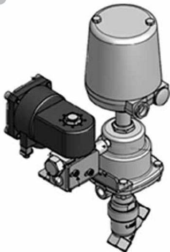
Рисунок 6.50. Клапан сбросной высокотемпературный: а) иностранного производства; б) отечественного производства
