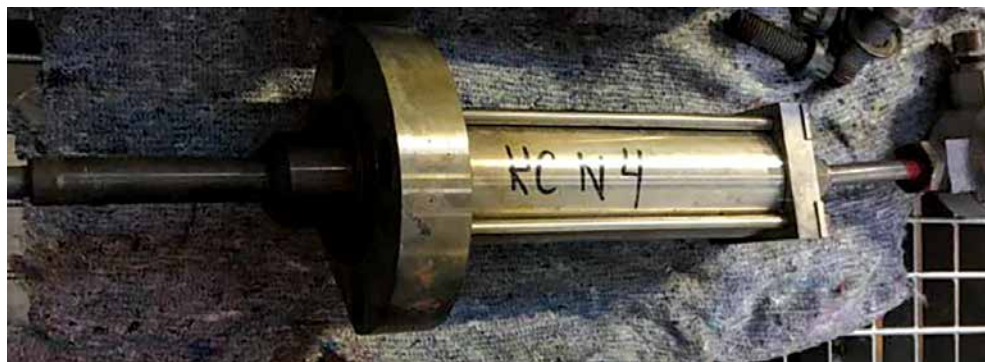
Рисунок 5.13. Разрушение наконечника воспламенителя старого типа (красная метка)
