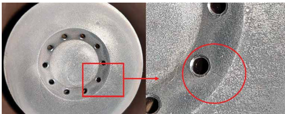
Рисунок 5.9. Бескартриджная крышка (наработка 15 000 часов)
