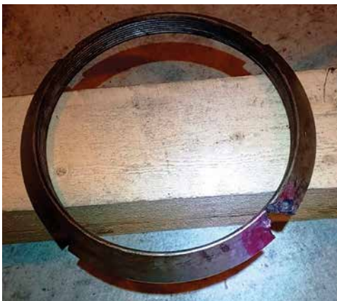
Рисунок 5.70. Гайка крепления рабочего колеса и разрез для ее удаления
