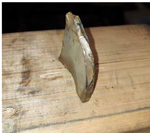
Рисунок 5.71. Посторонний предмет в рабочем колесе ЦБК
