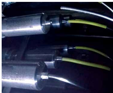
Рисунок 5.46. Обрыв термопары на выхлопе агрегата
