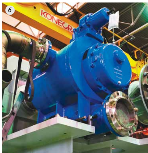
Рисунок 6.46. Главные масляные насосы: а) иностранного производства; б) отечественного производства
